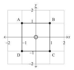
L'ensemble des sommets du carré est  $V = \{A, B, C, D\}$ . Une réflexion du carré par rapport à la droite x = 0 peut être représentée par la permutation (AB)(CD) qui donne la position finale des sommets.
